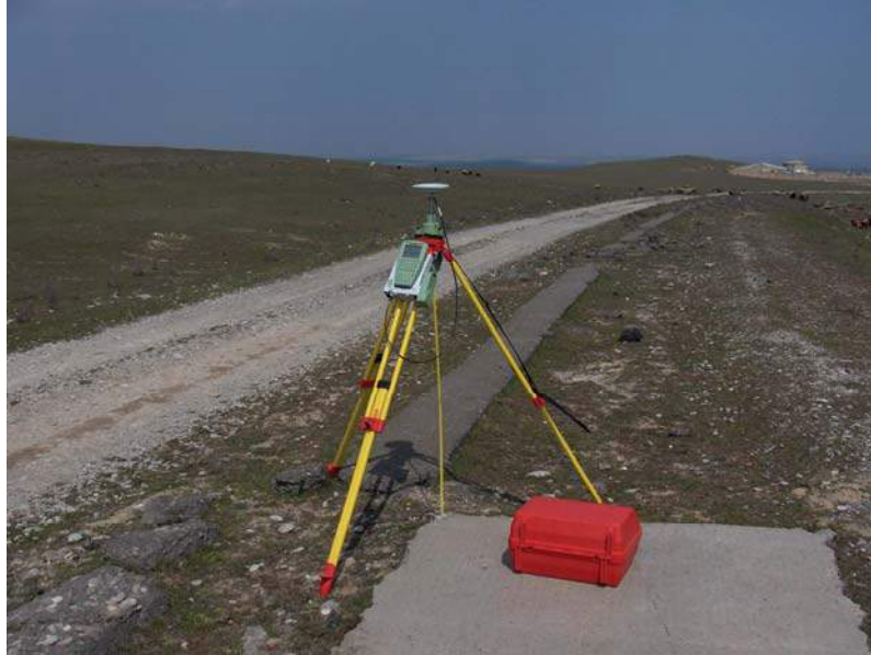
Şəkil 22.8. Fotoqrammetrik yer nəzarət nöqtələrinə GPS xidməti
